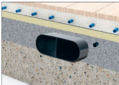
Canale piatto nello strato di compensazione (secondo DIN 18560-2)
